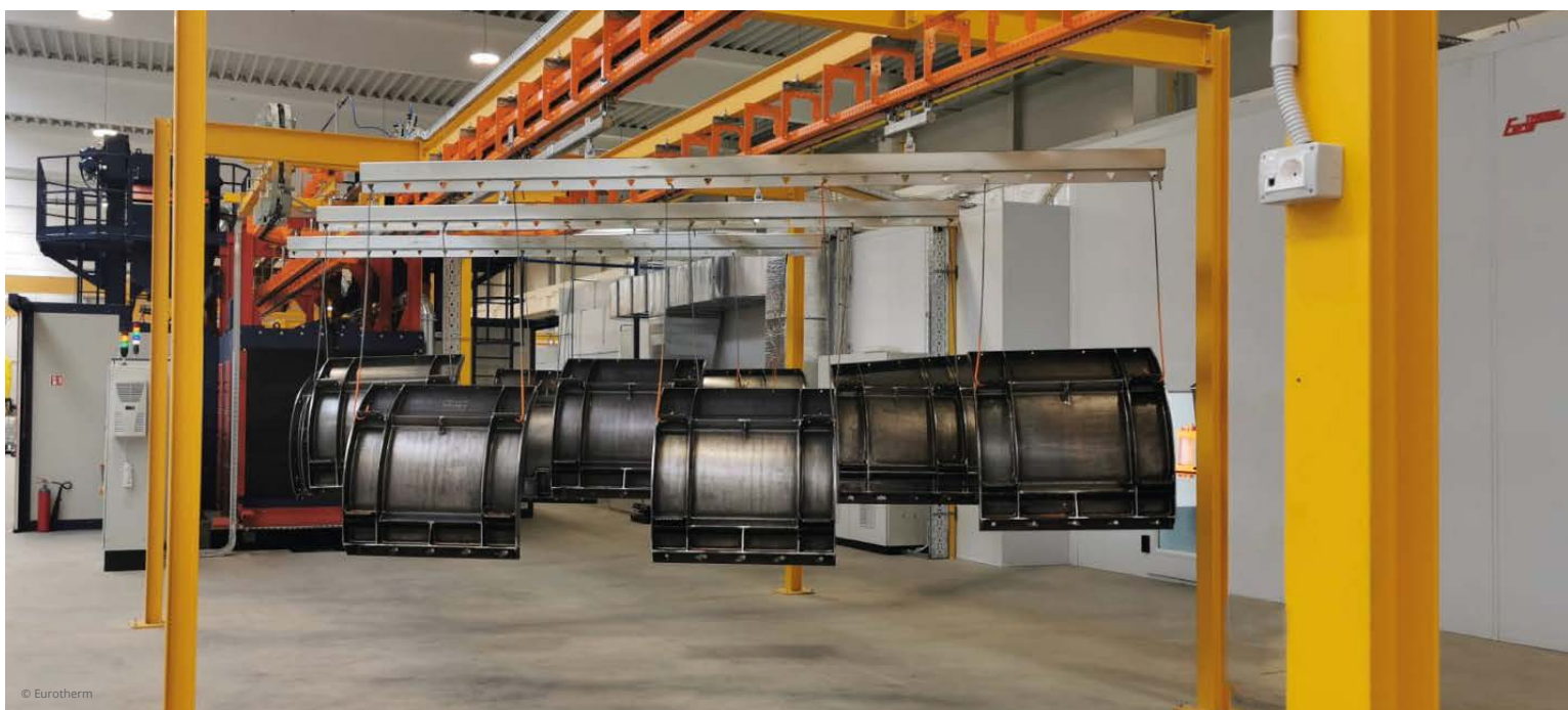
Il trasportatore aereo automatico power & free e l'area di carico e scarico.
