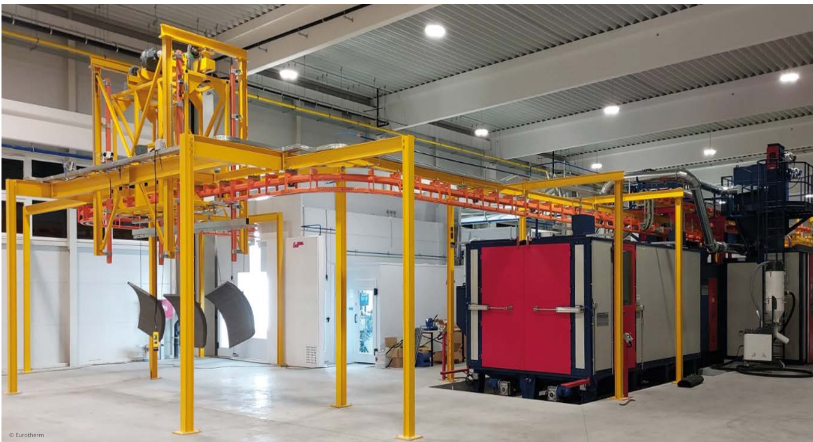
La linea di verniciatura a liquido con trasportatore aereo automatico Power & Free progettata da Eurotherm di Torino.
