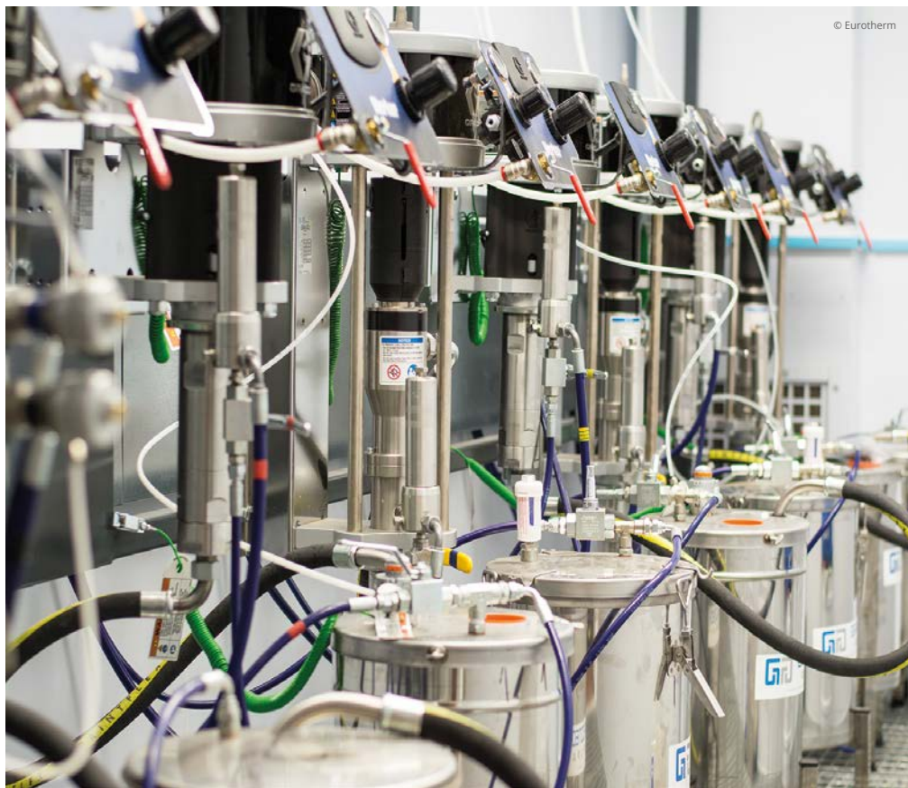
Primo piano delle pompe Merkur di Graco utilizzate per l'alimentazione della vernice.
