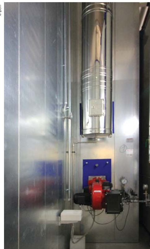
Uno dei due bruciatori di cui è dotato il forno di polimerizzazione.
