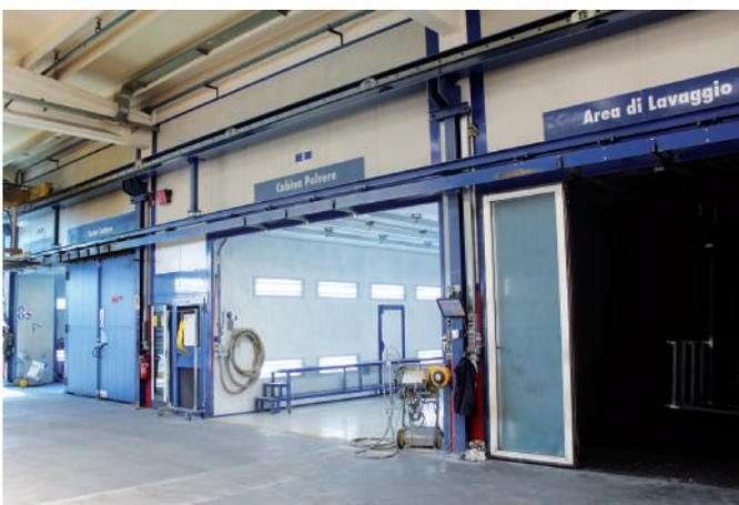
6- La cabina di granigliatura installata presso Colortec è separata dal resto dell'impianto di verniciatura.
