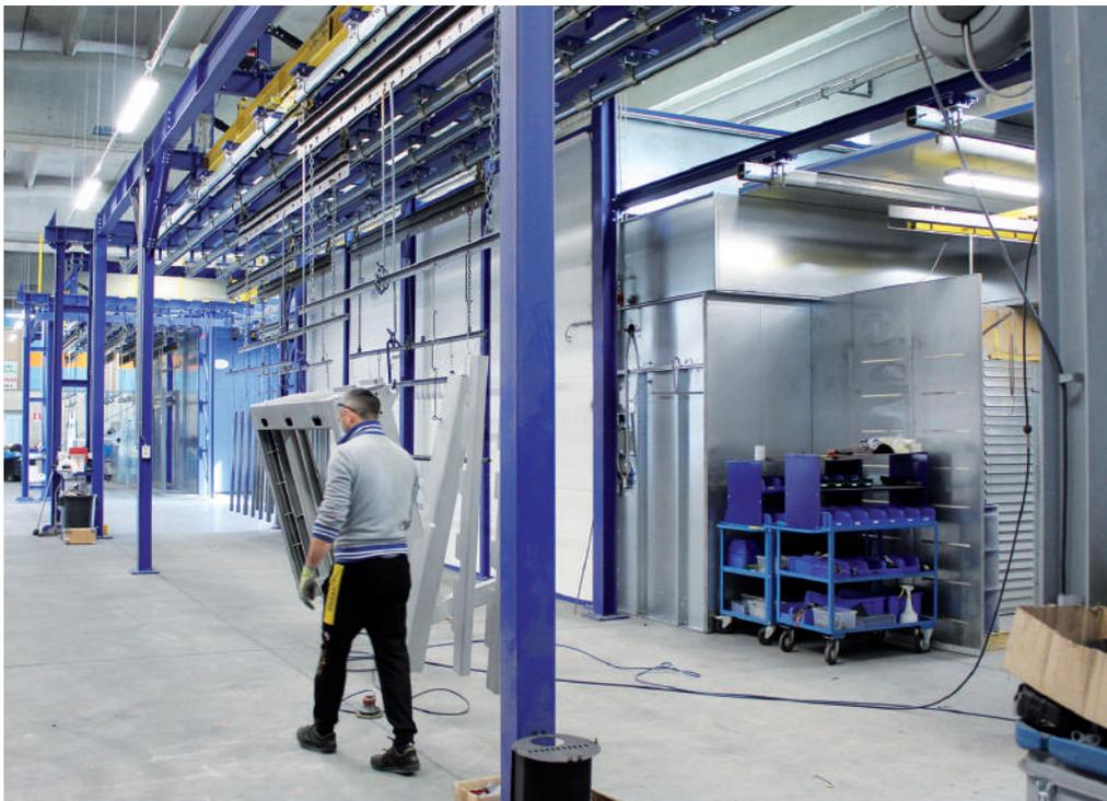
1 – Panoramica generale di un impianto compatto di Eurotherm costituito da 2 cabine, un forno e un discensore per la verniciatura di manufatti fino a 3.000 kg. L'impianto occupa un'area di 23 x 10 m in totale. Quello in foto è installato alla Lanzi di Agliano Terme in provincia di Asti.
