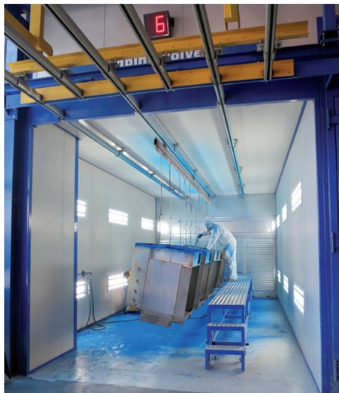
10 – La cabina di verniciatura a polveri. Da notare che i pezzi sono appesi al trasportatore e non appoggiati ad un cavalletto, come normalmente avviene.
