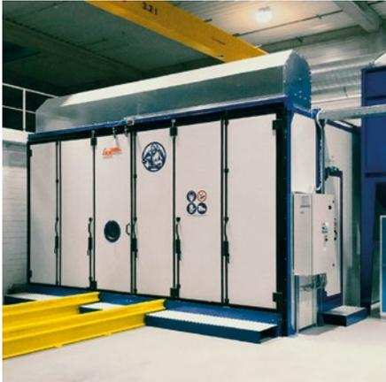
➤ Strahlkabinen mit totaler Rückgewinnung des Strahlmittels
