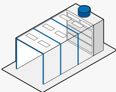
➤ Cabine de peinture avec **avant-corps** avec parois et toit en panneaux pré-isolés peints et éclairages
