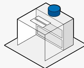
➤ **Paroi aspirante** avec parois et toit prolongés avec parois et toit en tôle galvanisée et éclairages
