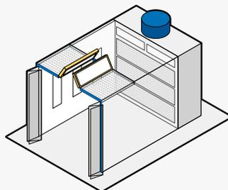
➤ Cabine de peinture à flux **oblique** avec entrée d'air au toit filtré et porte pliante
