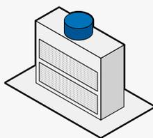
➤ **Paroi aspirante** avec 1<sup>ère</sup> filtration en carton ondulé et 2<sup>ème</sup> filtration en fibre de verre
