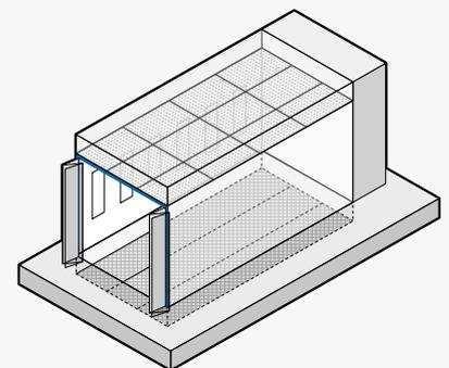
➤ Cabine de peinture pressurisée avec plenum d'introduction d'air filtré et aspiration au sol
