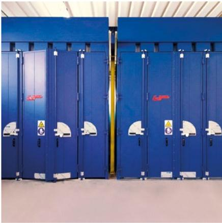
➤ Gas-Einbrennöfen bis zu 250°C
