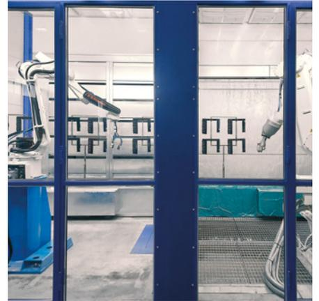
➤ Installation de peinture liquide automatique pas à pas avec convoyeur au sol
