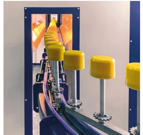
➤ Installations de peinture liquide automatiques en continu avec convoyeur au sol
